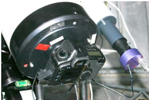
Chambre de Schmidt et APN, à droite : lunette guide et caméra PL1-M
