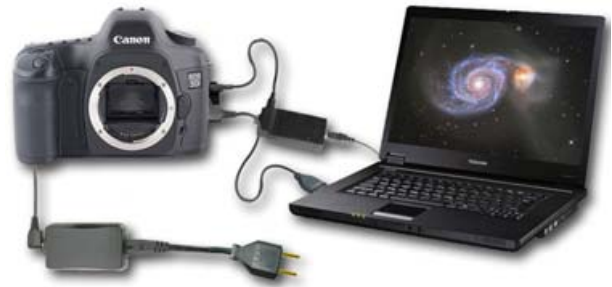
L'APN, son bloc d'alimentation, l'interface longue pose « Quick Remote », la connexion USB pour le stockage des images et l'ordinateur portable
