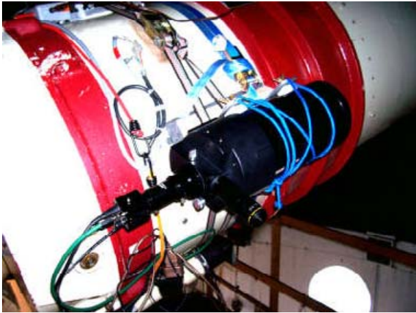
Montage du Maksutov avec sa caméra haute sensibilité en parallèle du tube du T620
