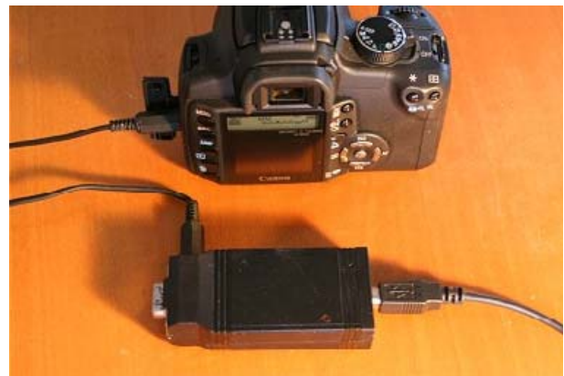
Interface QuickRemote permettant « d'attaquer » directement l'obturateur depuis IRIS.
