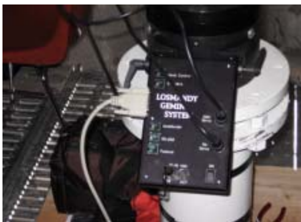
Platine électronique de la monture Titan Losmandy
