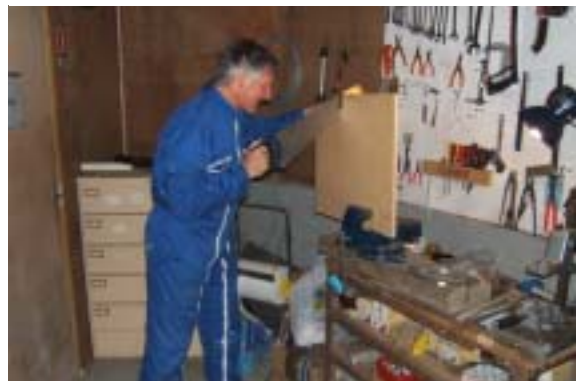
Atelier d'ébénisterie optique (débit des bagues pour le T62)
