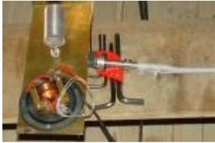
Mais nous avons aussi travaillé, la preuve avec un des montages testés : à droite, on aperçoit la fibre optique, à gauche la lampe au tungstène. Le tout est calé avec les *moyens du bord* et sera recouvert par un drap noir pour empêcher toute lumière extérieure.
